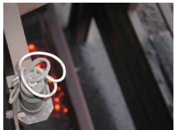
Высокогорский ГОК, пирометр Термоскоп-200, контроль температуры агломерата при загрузке в вагон без охладителя
